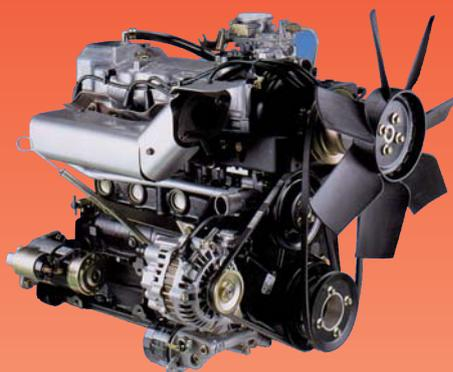
El motor Mitsubishi 4G64 de GLP es de bajo consumo y mantenimiento sencillo. La válvula de bloqueo del combustible está diseñada para detectar el vacío del motor y automáticamente bajarlo de revoluciones, si ocurriera una pérdida de presión del aceite o un sobrecalentamiento del motor o de la transmisión. Y, por supuesto, cumple la regulación europea de emisión de gases y de partículas "Euro stage 3".
