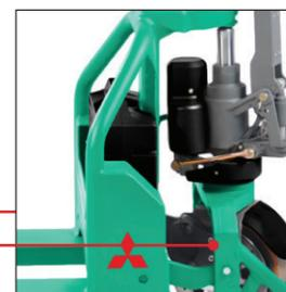
Motor de cubo de rueda sin escobillas ni necesidad de mantenimiento.
